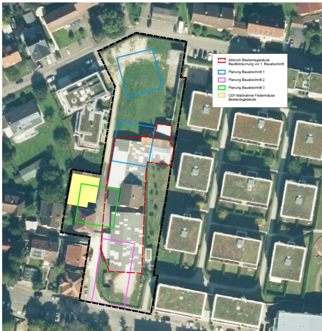
Übersichtslageplan Bauabschnitte 1 bis 3 + CEF-Maßnahme Fledermäuse
