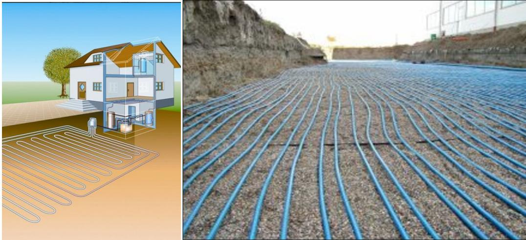
Abbildung 3.8: Prinzip Erdwärmekollektor
